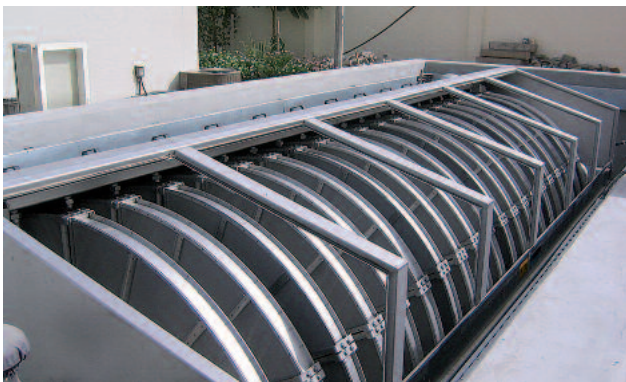
RoDisc® Scheibenfilter, das Mikrosieb zum Abscheiden extrem feiner partikulärer Feststoffe
