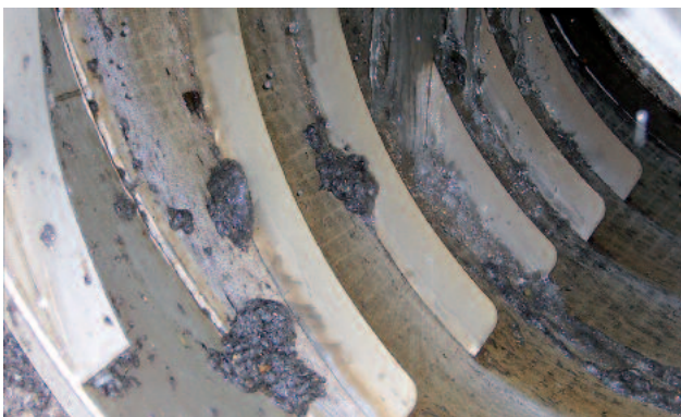
Feinstsiegung mit unserer Feinstsiebtrommel RoMesh®; gut erkennbar ist die schlammartige Konsistenz des Siebgutes
