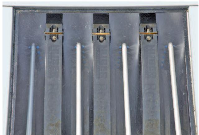
*Retrolavado de los filtros de disco mediante filtrado – no se requiere de agua externa de lavado*
