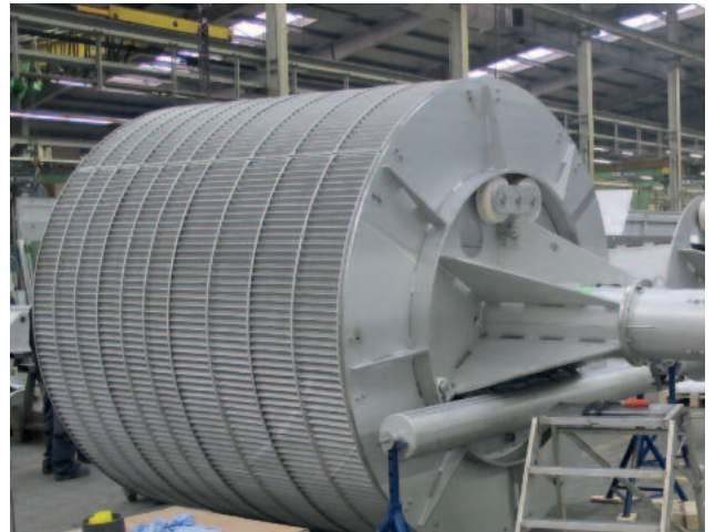
ROTAMAT® Perfore Plaka Izgara, 2600 mm çap (toplamda 6 ünite), 1 mm perfore aralığı ile
