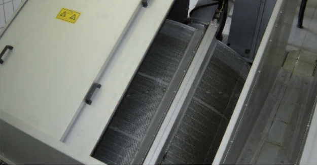
Hareket edebilen paslanmaz çelik kapaklı kanal içerisine kurulmuş ROTAMAT® Döner Tamburlu İnce Izgara, boyut 600 ila 3000
