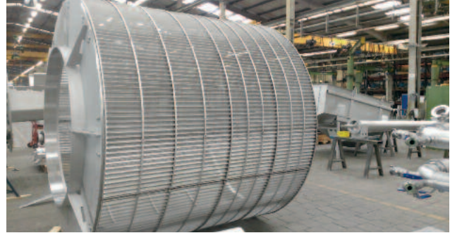
RPPS-Star sepet ızgara, 2600 mm çap, 1 mm perfore aralığı
