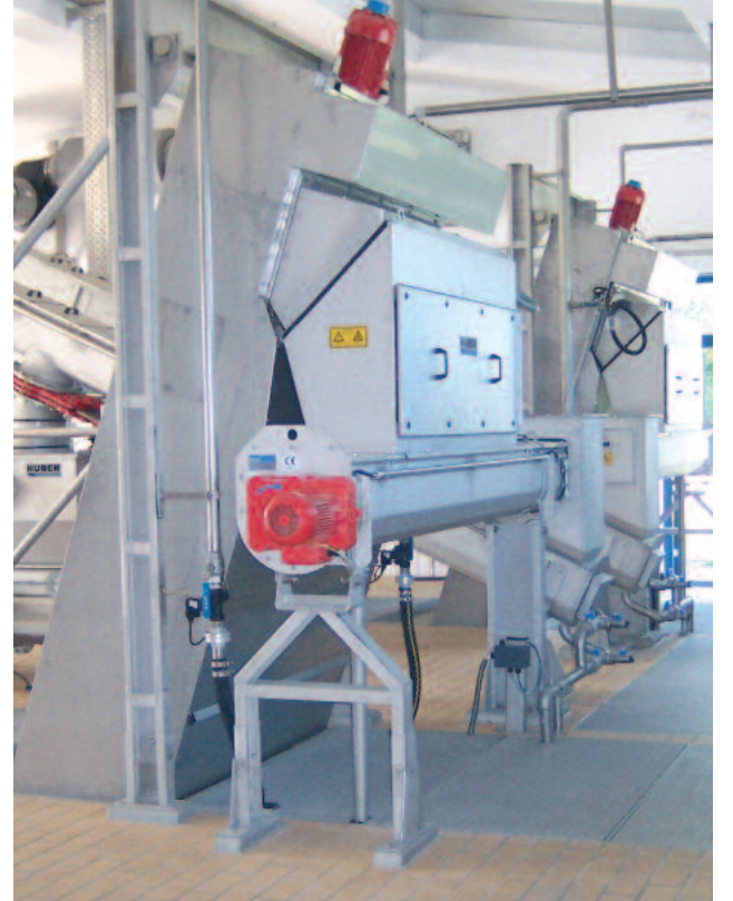
Izgara atıklarını helezon konveyör ile aktarım haznesinin içinden tahliye eden kapalı STEP SCREEN® Dikey SSV yandan görünümü.
